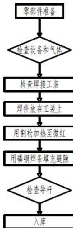
图4 焊接工艺及流程
