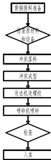
图1 端子生产工艺及流程
